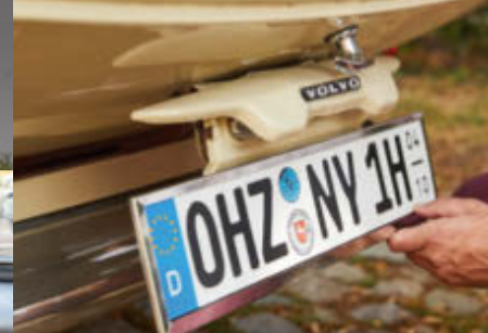
Kennzeichen und Beleuchtung klappen herunter, bleiben so auch mit offener Klappe ablesbar
