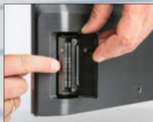
Die Festplatte des MSI Pro 24X lässt sich problemlos gegen eine SSD im 2,5-Zoll-Format austauschen.
