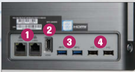
An der Rückseite hat der MSI zwei Netzwerkbuchsen 1, einen HDMI-Anschluss 2, zwei USB-3.0-Buchsen 3 und USB-2.0-Anschlüsse 4.
